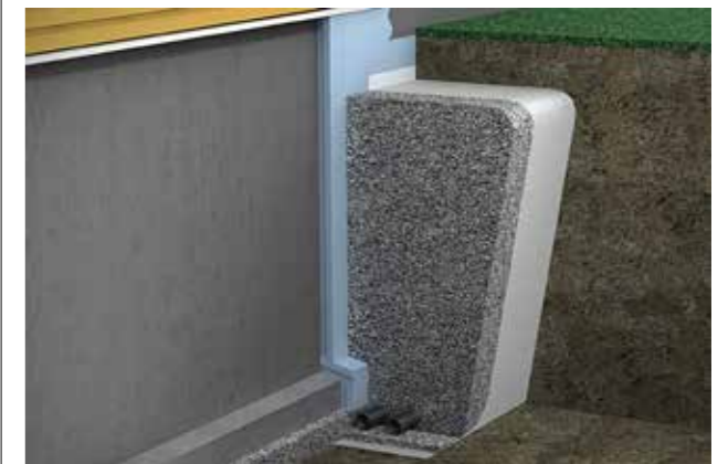
Plassering og omfylling av drensledning ved betongsåle. Støpeskjøt fundament/vegg bør ligge 50 mm under underkant golvstøp.
